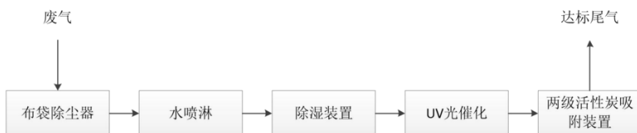
图 8.2-1 项目废气处理工程工艺流程图
